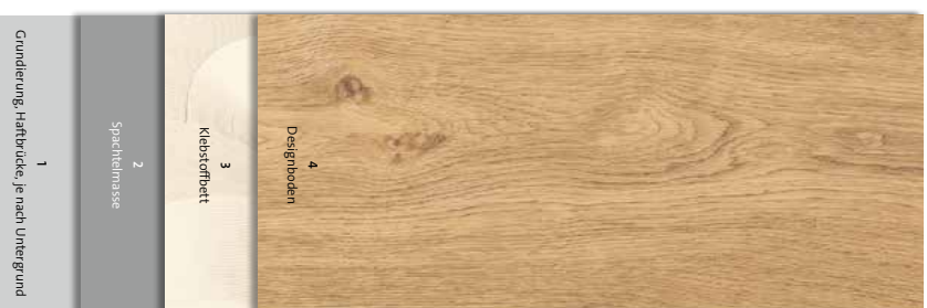
3. Die Arbeitsschritte definieren den finalen Fußbodenaufbau
